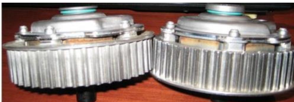
Tu widać jak grubość elementu jest kompensowana korkiem.
